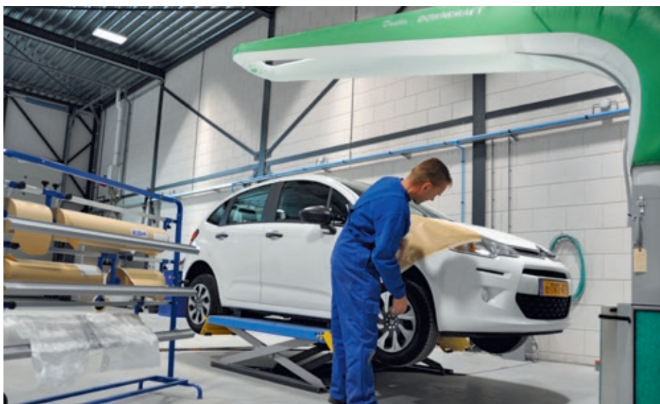
De Duster 3000 Downdraft is een mobiel afzuigstelsysteem. Via de 3,6 meter lange luifel (plenum genaamd) plenum wordt 93 procent direct boven de aanzuigkast omhoog geblazen, zeven procent gaat het plenum in. Hierdoor wordt een luchtstroom rond de auto gecreëerd en alle lucht wordt richting de aanzuigkast gestuurd. De viervoudige filtering zorgt voor schone lucht.
